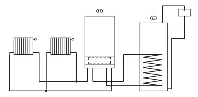
Radiators ®Boiler © Open vent DHW-cylinder or Vitocell
