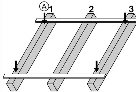
Snow loads > 1.25 kN/m<sup>2</sup>, ≤ 2.55 kN/m<sup>2</sup>
